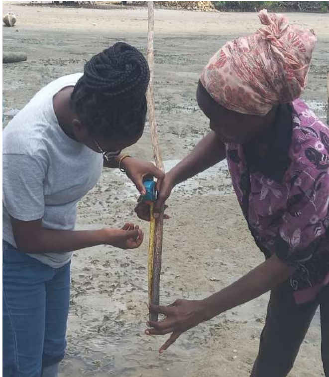
Kielelezo na. 5: Upimaji wa kina cha tope kwenye eneo lililochaguliwa kusimikwa kizimba (Picha: Halisi)
