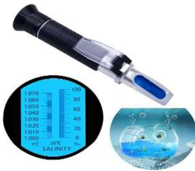
Kielelezo 15 Kifaa cha kupia kiwango cha chumvi kwenye maji
